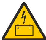
ZCB ZONA DE CARGA DE BATERÍAS
