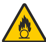
MCT PELIGRO MATERIAL COMBURENTE
